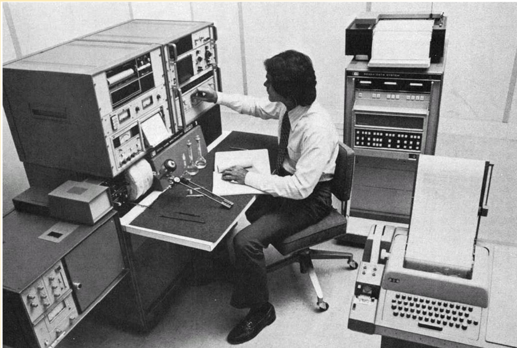
HP 5930 A « GC-MS-DS with oscilloscope » (1973)
