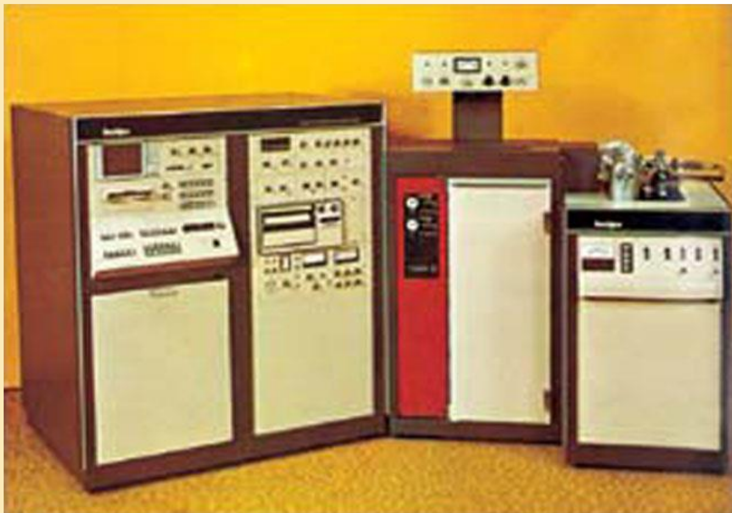
Finnigan Model 1015, le premier Quad-GC/MS avec data system intégré
